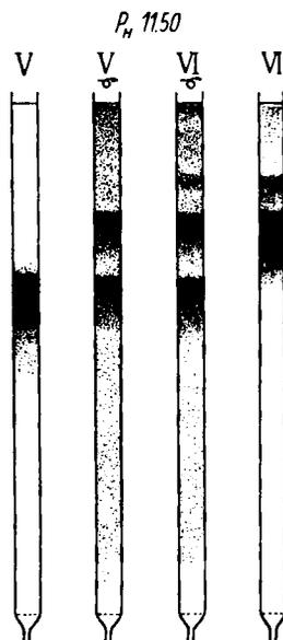
Abbild. 2. Chromatographische Analyse von V und VI vor und nach  $\rightleftharpoons$  der Isomerisierung an Cellulosepulversäulen 0,9  $\times$  20 cm; n-Butanol/0,2 m Phosphatpuffer,  $p_H$  11,50
